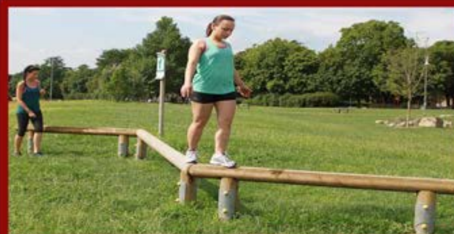
Attrezzo ginnico per equilibrio realizzato in legno di pino trattato per esterno con ancoraggi in metallo zincato
