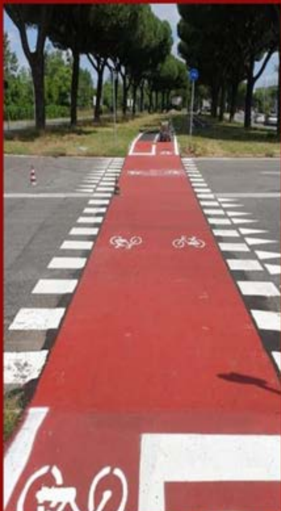
Pista ciclabile colore rosso che prosegue anche lungo l'attraversamento stradale
