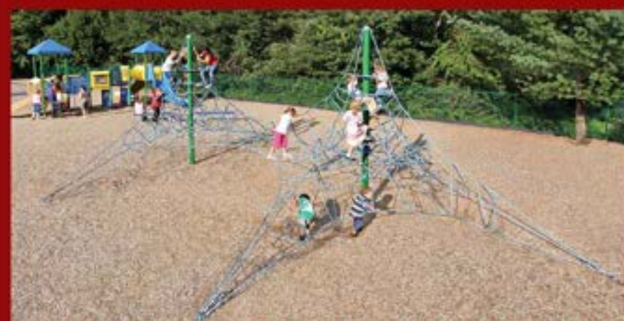
Attrezzo "Piramide" realizzato con un palo metallico centrale e con corde di polipropilene con giunti protetti in plastica
